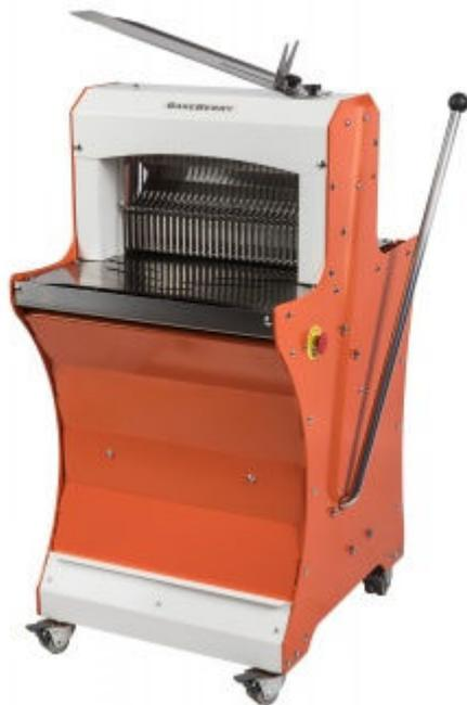
Хлеборезательная машина BakeBerry предназначена для нарезания различных видов хлеба, размер которого не превышает размеров режущего устройства. Максимальная длина хлеба — 515 мм, максимальная высота хлеба — 190 мм. Хлеб должен быть испечен не более чем 24 часа назад и не быть слишком жестким для ножей.
