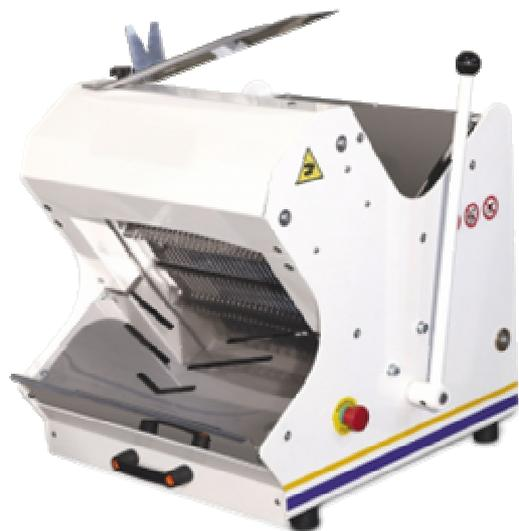
Хлеборезательная машина BakeBerry предназначена для нарезания различных видов хлеба, размер которого не превышает размеров режущего устройства. Максимальная длина хлеба — 515 мм, максимальная высота хлеба — 190 мм. Хлеб должен быть испечен не более чем 24 часа назад и не быть слишком жестким для ножей.
