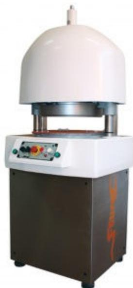
Тестоделители-округлители BakeBerry используется для деления и округления дрожжевого теста. Ножи делят тесто по объемному принципу на 30 равных частей.
